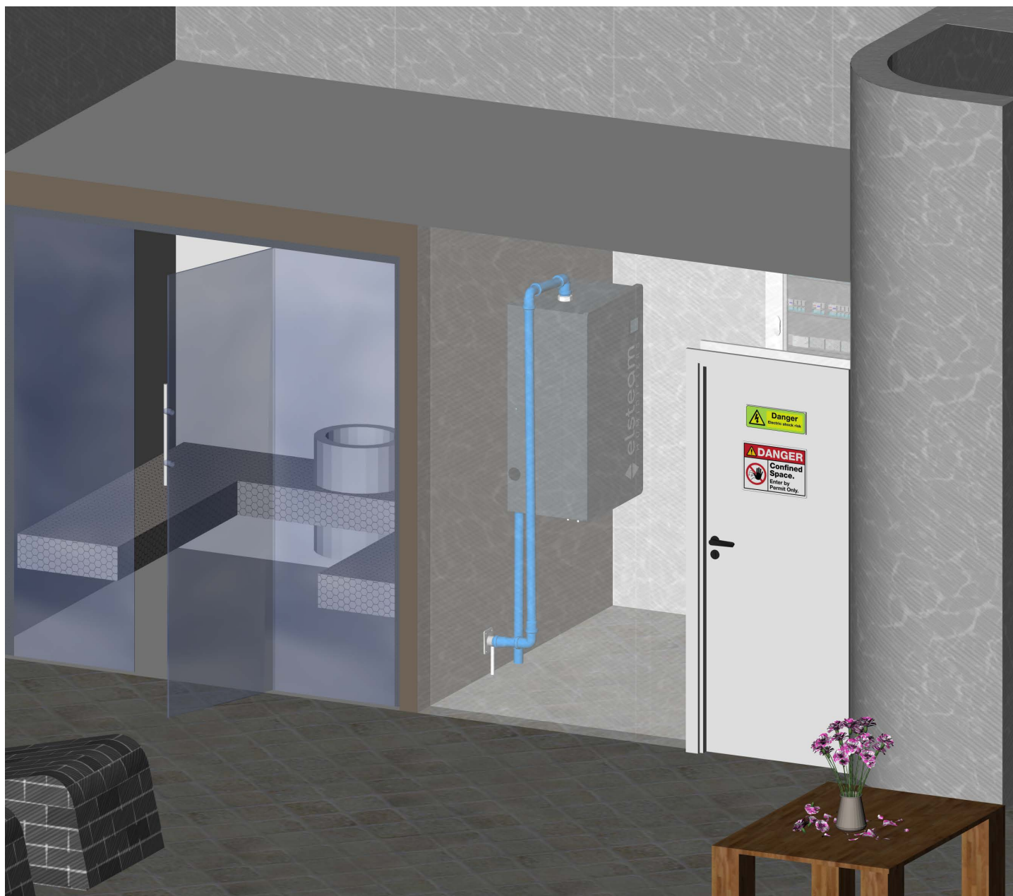
Fig. 10. Esempio installazione in vano tecnico di un bagno turco
